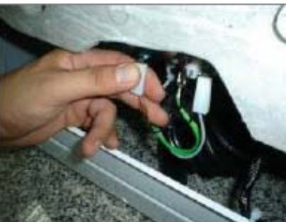
Débrancher la résistance
