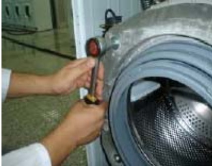
Démonter les axes des amortisseurs
