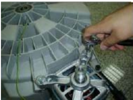
Démonter le moteur
