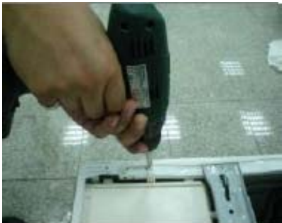
Démonter la trappe d'accès
