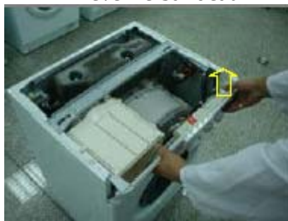
Dévisser les vis de plinthe
