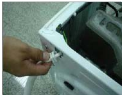
Débrancher le tuyau pressostat
