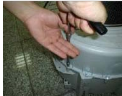
Démonter la cuve
