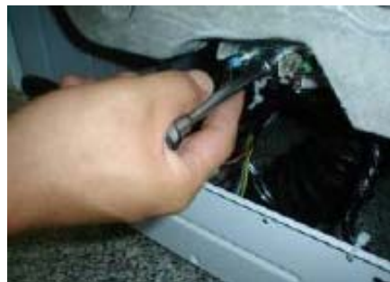
Démonter la résistance
