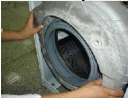
Dévisser les vis du contrepoids supérieur
