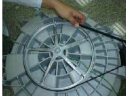
Démonter la cuve
