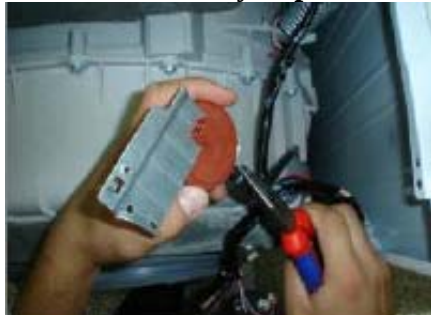
Démonter le collier tuyau vidange
